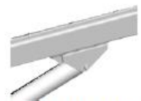
③レール&支柱連結金具の取付け
