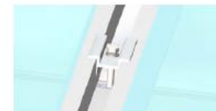
②中間金具の取付け
