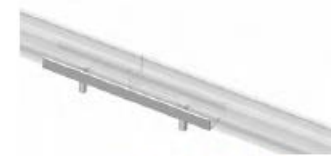
④縦レールの取付け
