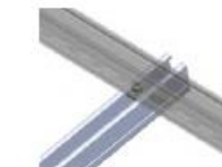
⑥ 縦レールと横レールの連結
